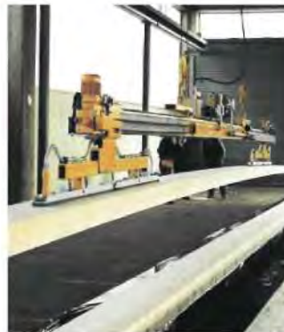
VWLB mit motorisch verstellbaren Saugplatten
