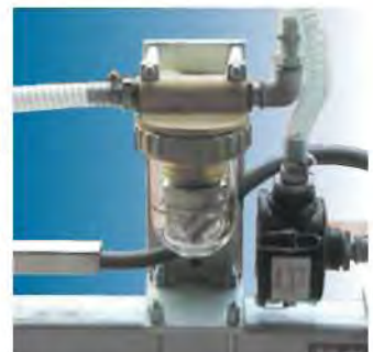
Wasserabscheider für feuchte und leicht naße Hölzer oder Bohlen.
