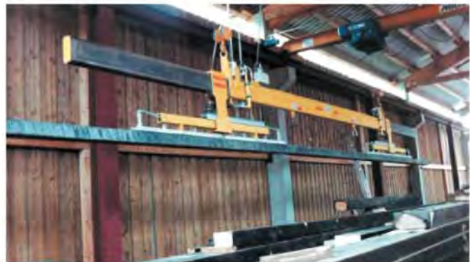
VWLB für in Folie umwickelte Leimbinder bis 20 Meter Länge und separater Vakuum-Energieeinheit
