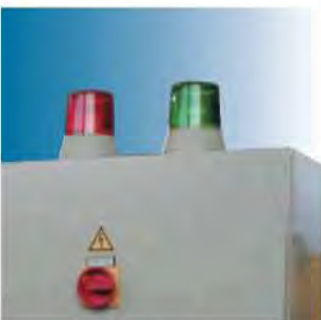
Optische Warneinrichtung die bei Betriebsbereitschaft grün leuchtet und bei zu niedrigem Vakuum rot aufblitzt.
