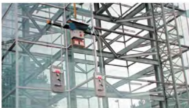
VacuBoy Vario mit "Battery-Tool" beim vertikalen Transport von Glasscheiben
