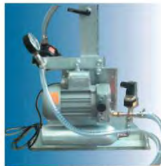
Vakuumerzeuger mit Rückschlagventil, Eco-Modul und Sicherheitsspeicher
