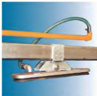
Pendelnd aufgehängte Saugplatten für den Transport schmaler, labiler Hölzer
