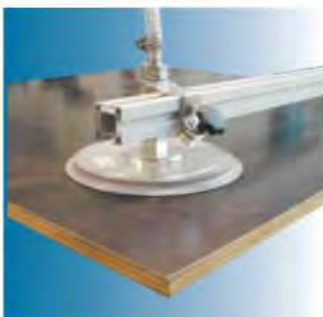
Starr befestigte Saugplatte für den Transport von eigenstabilen und dicken Lasten.
