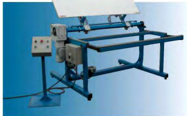
VacuStand VS II-180E während des Wendevorgangs. Während des Wendevorgangs ist ein Lösen des Werkstücks, durch integrierte Sicherheitseinrichtung, nicht möglich.
