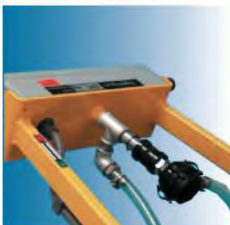
Manipuliergriff mit angebaute Hand-schiebeventil zum Saugen und Lösen.
