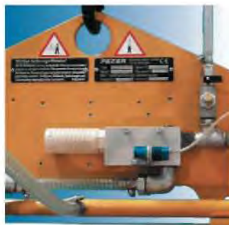
"Pneumatic-Tool" für reinen Druckluft-Betrieb mit integrierter pneumatischer Warneinrichtung.
