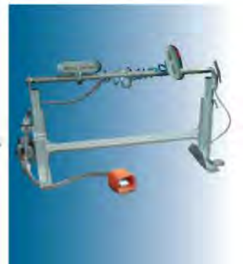
VacuStand II-AL mit 2 Saugplatten, die um 90° gedreht werden können
