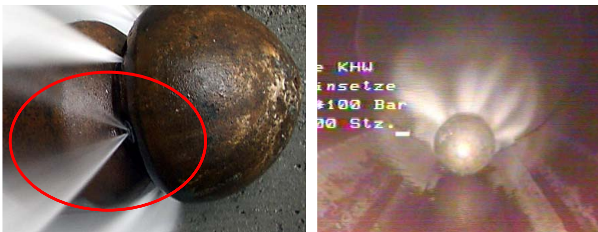
Bild 81: Verstopfter Düseneinsatz (links), Düse mit unsymmetrischem Strahlbild (rechts)
