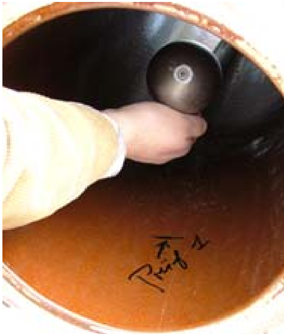
Bild 135: Fall-Versuch: Anheben der Düse
