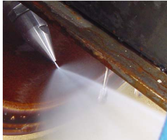
Bild 129: Belastung durch einen Hochdruck-Einzelstrahl (stationär)
