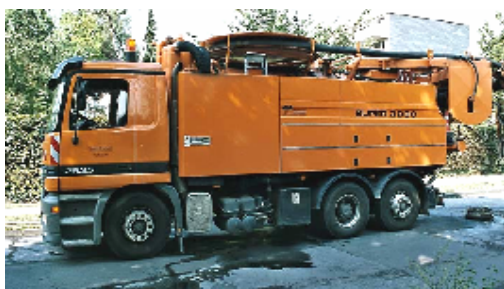
Bild 10: Kombiniertes Spül- und Saugfahrzeug mit Wasseraufbereitung
