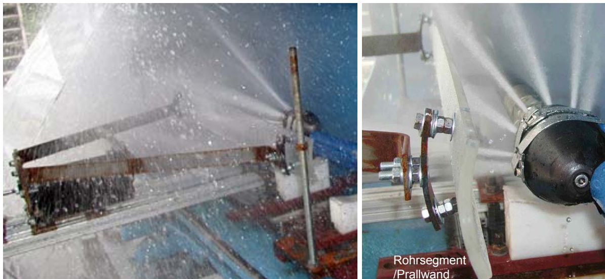
Bild 86: Düsen-Versuchsstand zur Ermittlung der Lösewirksamkeit von HD-Strahlen
