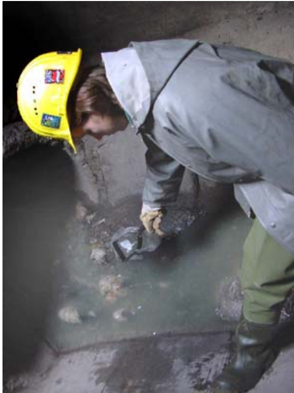
Bild 24: Probenentnahme mit einem Kanalschaber
