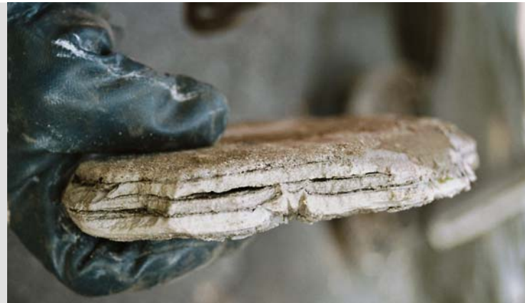
Stück einer verfestigten Ablagerung
