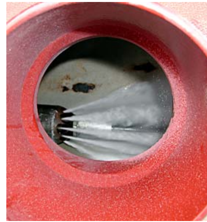
Bild 132: Prüfdüse liegt im Rohr frei auf
