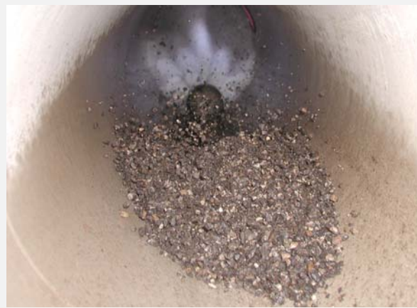
Bild 125: Prüfgeschiebe aus Kalkstein-Edelsplitt
