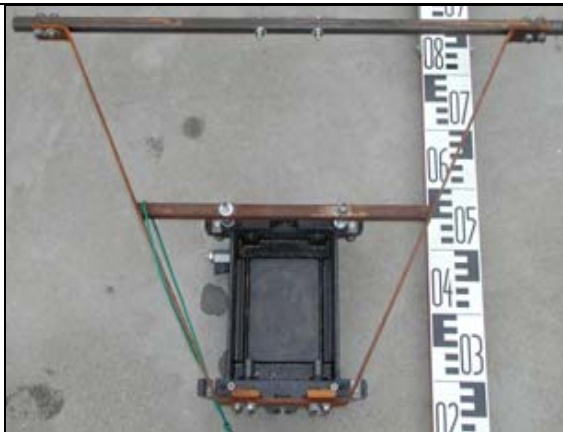
Bild 89: Stahlrahmen auf Rollenlager
