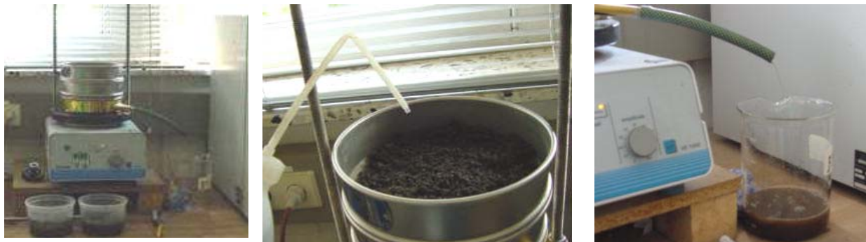
Bild 25: Abschlämmen der feinen Bestandteile
