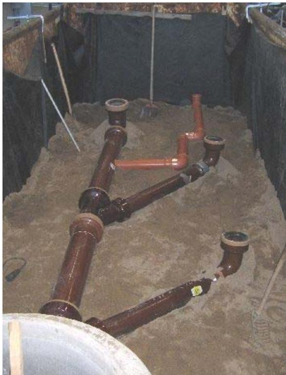
Abb. 28: Netzaufbau im mittelformatigen Versuchsstand (Sicht ausgehend vom Anschlusspunkt)
