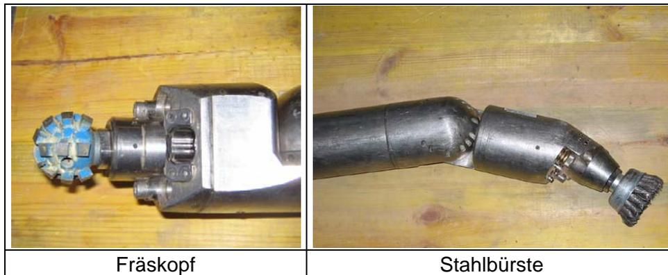
Abb. 29: Geräte zur Entfernung von Ablagerungen
