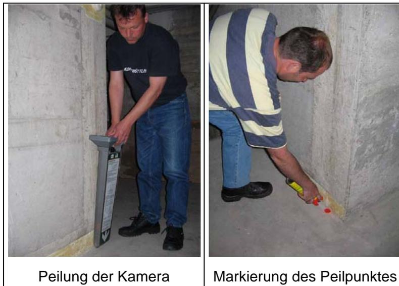
Abb. 13: Peilung der ORION L beim Einsatz in Würzburg (aus [12])
