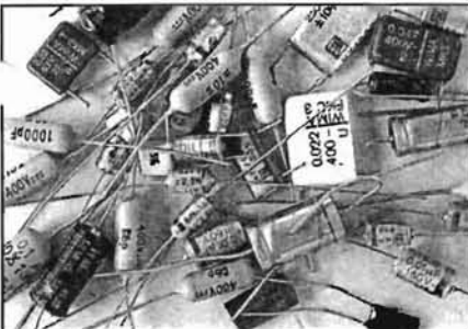
Kondensatoren können elektrische Ladungen speichern. Die wichtigsten sind: Elektrolyt-, Keramik- und Wickelkondensator.
