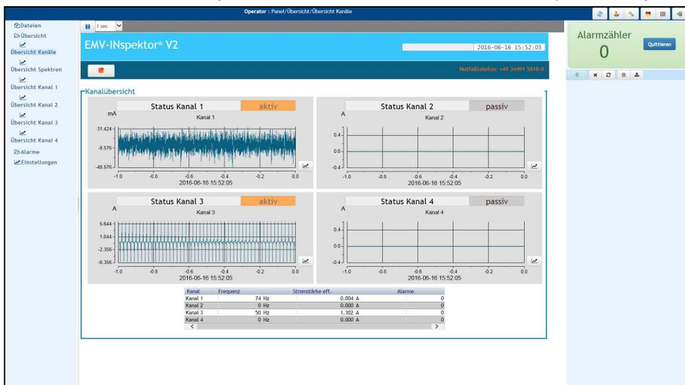
In der Kanalübersicht erhalten Sie Informationen über den aktuellen Stromverlauf, den zugehörigen Effektivwert, die Hauptfrequenz und die Anzahl der Alarme für jeden Kanal. Der Link „Übersicht Spektren“ führt Sie zu einer Seite ähnlichen Aufbaus, alleiniger Stromverlauf im Zeitbereich ist durch das entsprechende Frequenzspektrum ersetzt. Detaillierte Informationen, sowie Möglichkeiten der Kanalkonfiguration finden Sie auf den kanalspezifischen Seiten, z.B. „Übersicht Kanal 1“.
