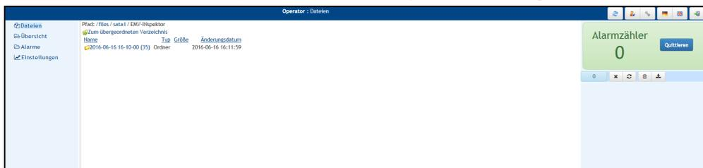
Auf dieser Seite der Weboberfläche befindet sich die Auflistung aller gespeicherten Messdaten in chronologischer Reihenfolge. Die vorhandenen Datensätze können Sie hier herunterladen und / oder öffnen. Das Löschen einzelner Messdaten oder ganzer Ordner ist mit einem Rechtsklick möglich.
