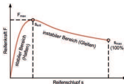
Bild 2-20 Qualitative Darstellung der Kraft/Schlupf-Kennlinie am Reifen
