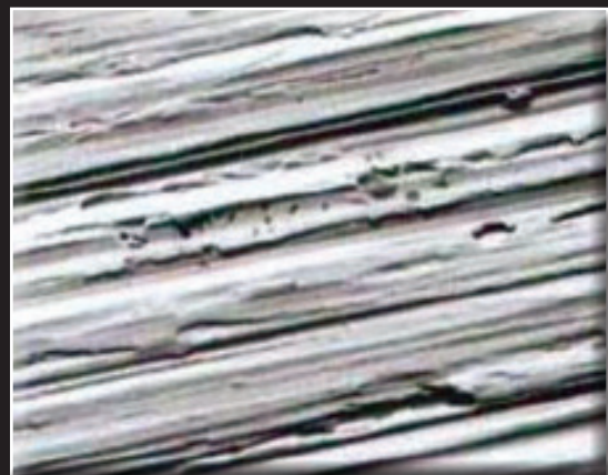
Oberfläche geschliffen Korn 320, 650-fach vergrößert
