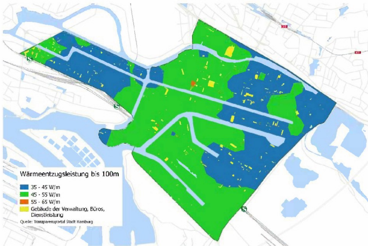
Abbildung 51: Wärmeentzugsleistung bis 100 m (ZEBAU nach Geologisches Landesamt, 2016).
