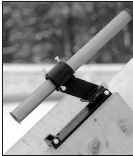
Abb. 1: Einfache Peilvorrichtung aus einem dünnen Metallrohr und einer ausgerichteten Sucherhalterung
