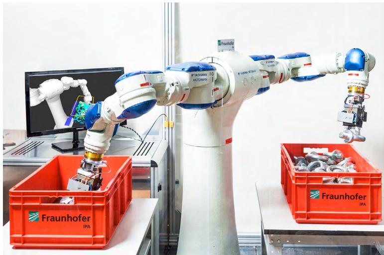
**Mithilfe des Maschinellen Lernens wird der Griff-in-die-Kiste immer weiter verfeinert. Im Forschungsprojekt »DeepGrasping« entsteht aktuell eine virtuelle Lernumgebung für Roboter.**
