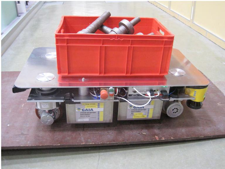
**Fahrerlose Transportsysteme müssen Lasten unterfahren, um sie aufnehmen zu können. Sie sollten also möglichst flach sein. Das neu konstruierte omnidirektionale Antriebsmodul kommt deshalb mit einem sehr geringen Bauraum oberhalb des Rades aus. (Quelle: Fraunhofer IPA)**
