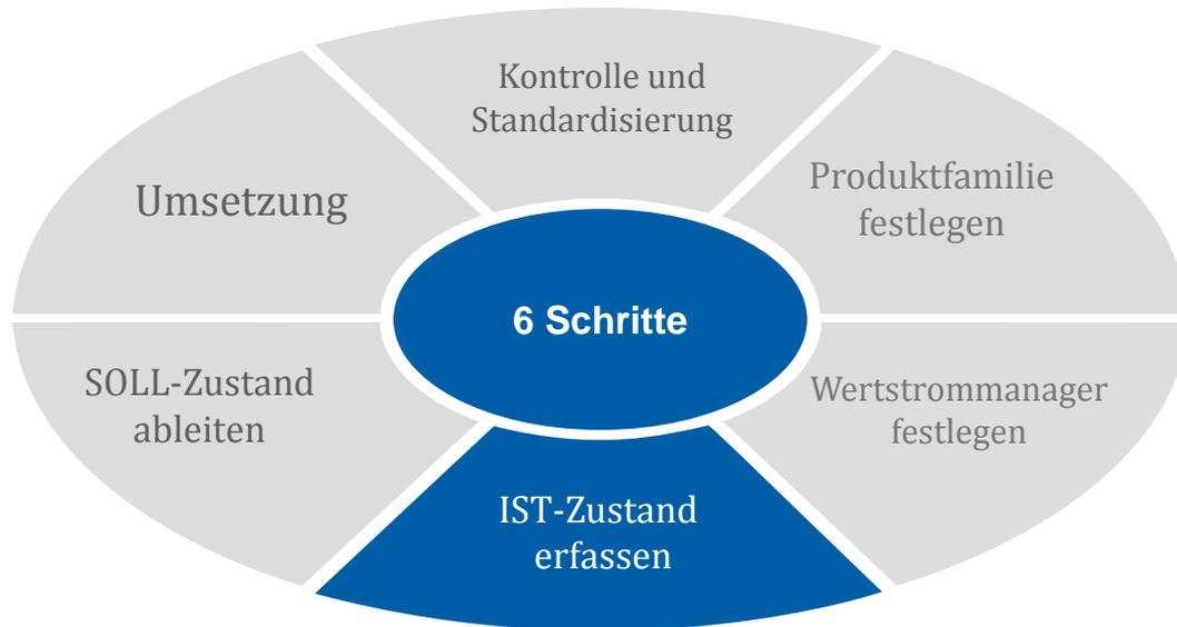
Im dritten Schritt wird nun der IST-Zustand erfasst. Hierbei wird die Fabrik bzw. der Produktionsprozess mit Hilfe einer standardisierten Symbolik visualisiert. Aufgenommen wird sowohl der Material- als auch der Informationsfluss.
