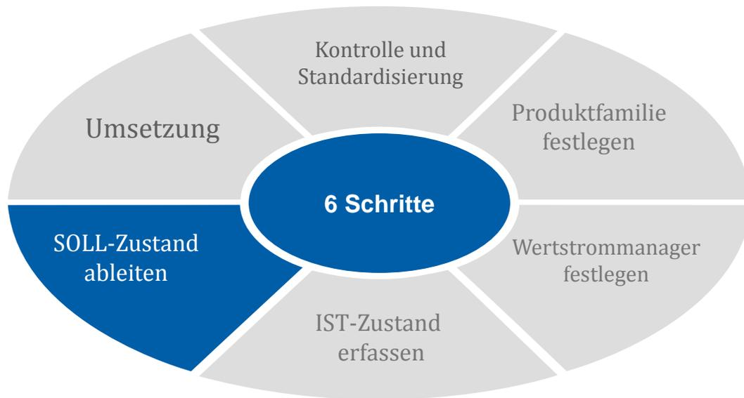
Im vierten Schritt wird der verbesserte SOLL-Wertstrom skizziert. Das nachfolgend beschriebene Vorgehen dient als Leitfaden bei für die Entwicklung eines optimierten SOLL-Konzepts.
