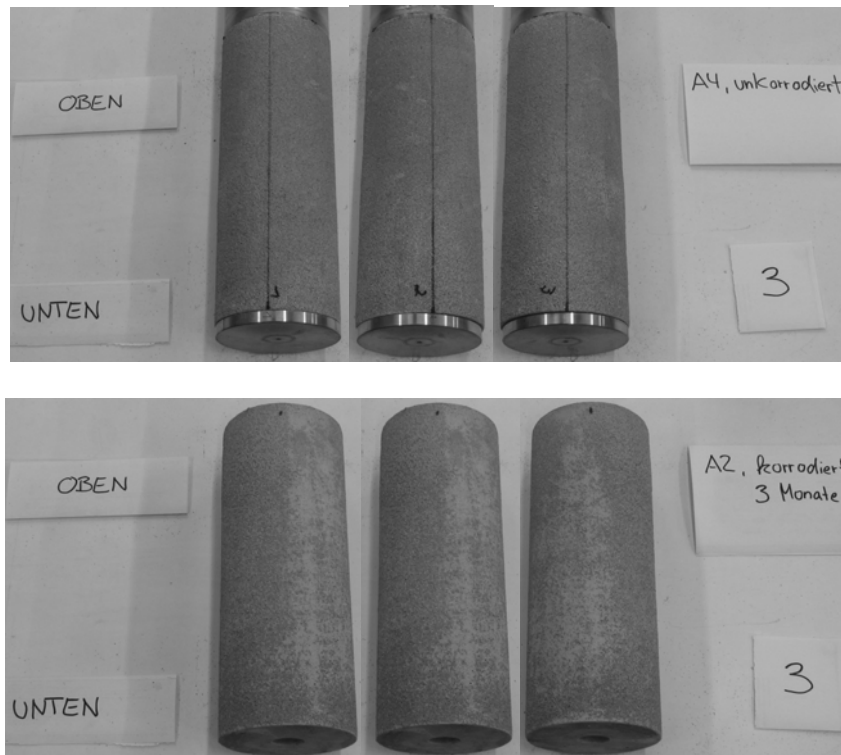
Bild 3.5 Oberfläche der Zementkörper nach dem Ausziehversuch (oben: unkorrodiert; unten: 3 Monate korrodiert)
