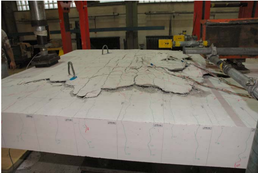
Abbildung 4.12: Versagensbild des Versuchsträgers SF-Q5
