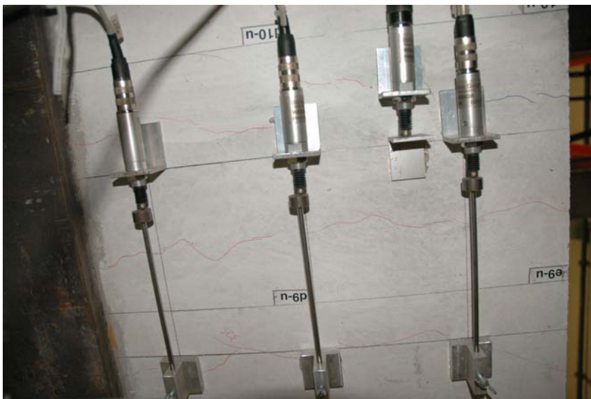
Abbildung 3.11: Wegaufnehmer PMW an der Trägerunterseite
