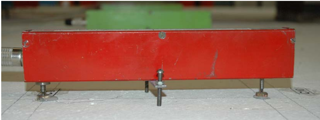
Abbildung 3.12: Setzdehnungsmesser an der Trägeroberseite
