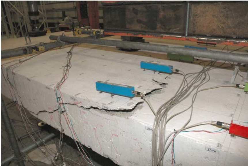
Abbildung 4.8: Versagensbild des Versuchsträgers SF-Q3
