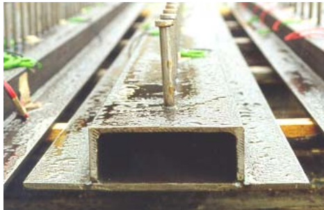
Abbildung 2.10: Querschnitt eines Verbundträgers mit Hutprofil
