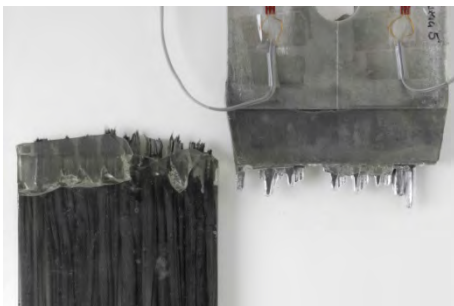
Abbildung 6-39 Bruchbilder der Bauteilversuche mit Carbonfasern
