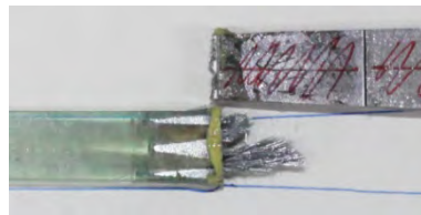
Abbildung 6-33 Bruchbilder von ausgewählten Auszugsversuchen der mit G-Fasern verstärkten Proben; Auswahlkriterien: maximale (relative) Bruchkraft und Versagensstelle
