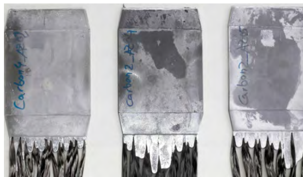
Abbildung 5-20 Drei mit Carbonfasern und Aluminiummatrix hergestellte Bauteile
