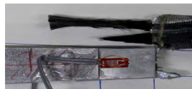
Abbildung 6-28 Bruchbilder von ausgewählten Auszugsversuchen der mit C-Fasern verstärkten Proben; Auswahlkriterien: maximale (relative) Bruchkraft und Versagensstelle
