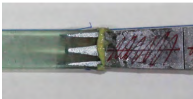
Abbildung 6-33 Bruchbilder von ausgewählten Auszugsversuchen der mit G-Fasern verstärkten Proben; Auswahlkriterien: maximale (relative) Bruchkraft und Versagensstelle
