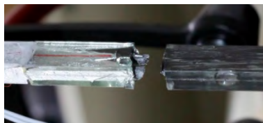
Abbildung 6-28 Bruchbilder von ausgewählten Auszugsversuchen der mit C-Fasern verstärkten Proben; Auswahlkriterien: maximale (relative) Bruchkraft und Versagensstelle
