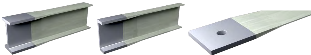
Abbildung 1-3 Visualisierung des Lösungsansatzes am Beispiel verschiedener Profile aus GfK; links : Doppel-T-Profil; mittig : U-Profil; rechts : Flachprofil
