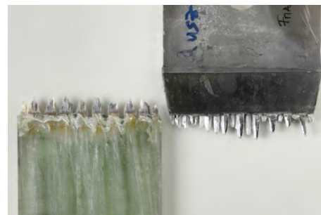
ALG8_BT5 ( F_{\max} = 45.5 kN)
