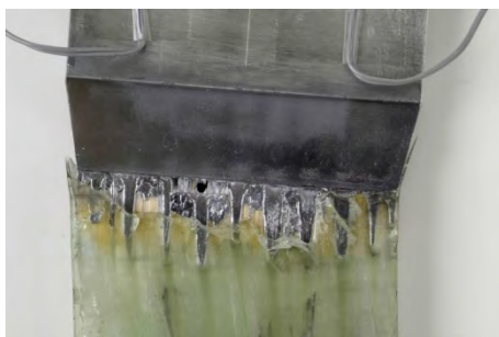
Abbildung 6-42 Bruchbilder der Bauteilversuche mit Glasfasern
