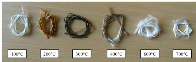
Abbildung 5-22 Verfärbung an AR-Glasfasern unter steigender Temperatur, aus [72]
