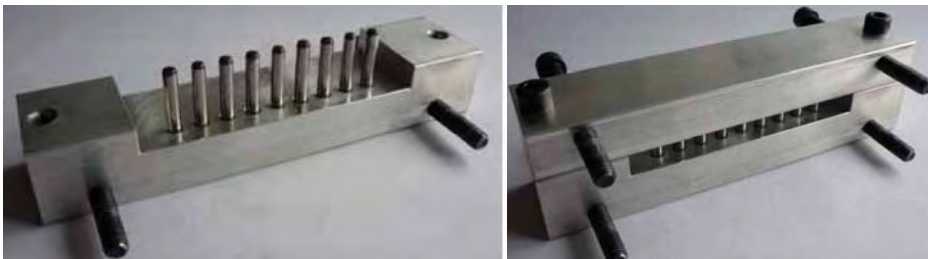
Abbildung 5-15 Einspannvorrichtung; links : unterer Teil oben offen; rechts : geschlossen
