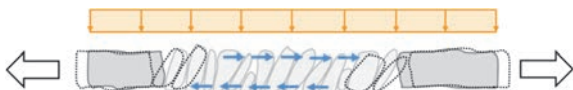
Bild 2 Die schräggestellten Steine bilden bei Vertikallast zusätzlichen Horizontaldruck auf die Mauerseiten aus
