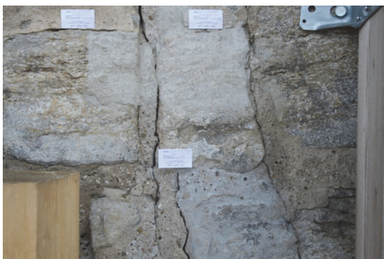
Bild 16 Schlämmpfropfen vor Ort, leicht erodierte Oberfläche, gereinigt - Probe 10 Rezeptur Kalksteinmehl / Quarzmehl 1:1 - Bindemittel Syton X 30, Probe 11 Rezeptur Kalksteinmehl / Quarzmehl 1:1 – Bindemittel Ludox HSA, Probe 12 Rezeptur MPA Weimar – Kalkstein grob, grau 2/492
