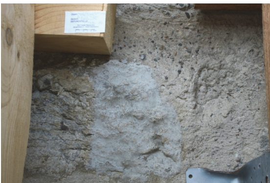
Bild 21 Schlammproben vor Ort, tief reichende Zerklüftung - Probe 16 Rezeptur Kalksteinmehl / Quarzmehl 1:1 – Bindemittel Syton X 30
