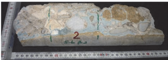
Bild 15 Prüffähiger Bereich aus dem Bohrkern 5-6 mit Lage des Prüfkörpers.
