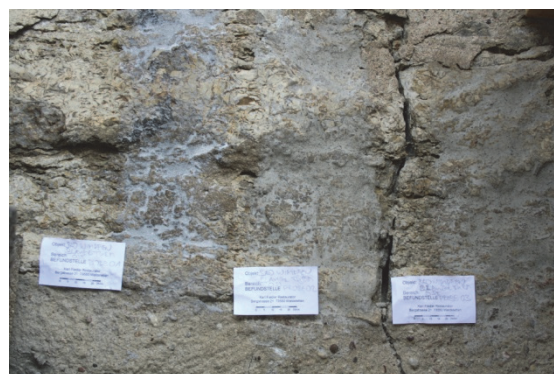
Bild 10 Schlämmpfropfen vor Ort Zerklüftete oberflächennahe Steinzone – Probe 01 Rezeptur MPA Weimar – Kalkstein grob, grau 2/492, Probe 02 Rezeptur Kalksteinmehl / Quarzmehl 1:1 – Bindemittel Syton X 30, Probe 03 Rezeptur Kalksteinmehl / Quarzmehl 1:1 – Bindemittel Ludox HSA
