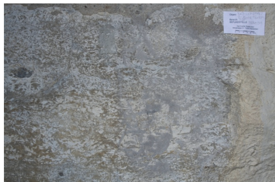
Bild 15 Schlammproben vor Ort, leicht erodierte Oberfläche, gereinigt – Probe 09 Rezeptur MPA Weimar – Kalkstein grob, grau 2/492
