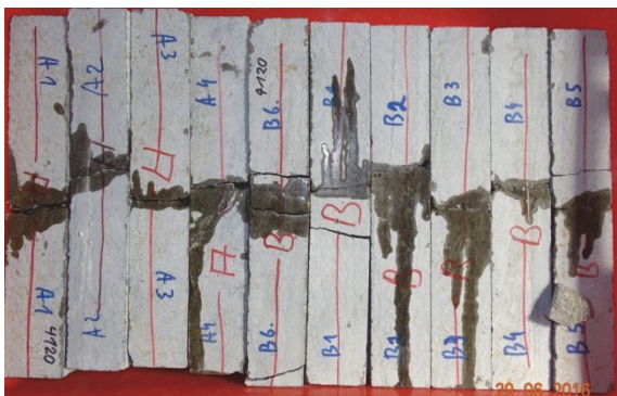
Bild 3 Geklebte Prüfkörper nach der Messung der Biegezugfestigkeit
