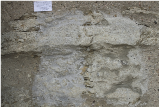
Bild 19 Schlammproben vor Ort, tief reichende Zerklüftung – Probe 14 Rezeptur MPA Weimar - Kalkstein grob, grau 2/492, Probe 15 Rezeptur Kalksteinmehl / Quarzmehl 1:1 – Bindemittel Syton X 30
