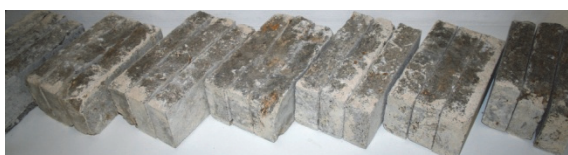
Bild 6 Probekörper aus Muschelkalk
