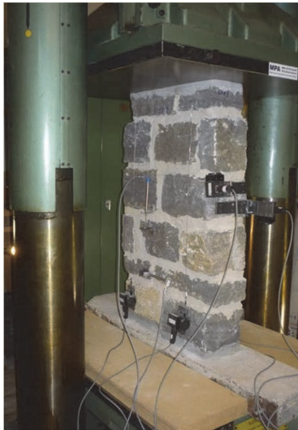
Bild 6 Anordnung der Wegaufnehmer auf den Prüfwänden
