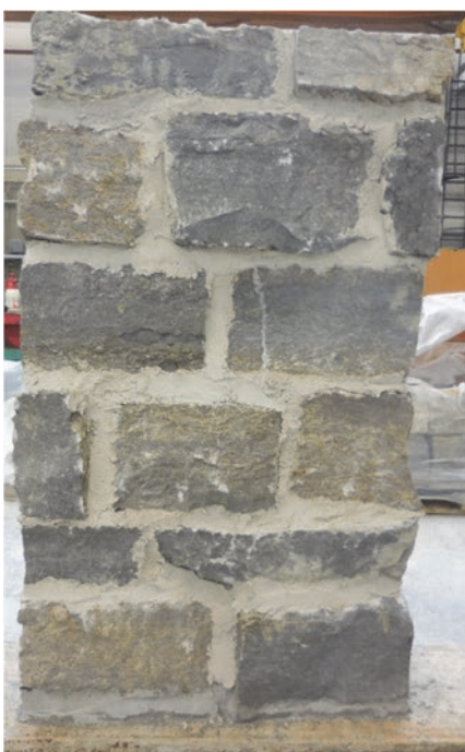
Bild 4 Kleinformatiger Mauerwerksprüfkörper im Maßstab 1:2 zur Ermittlung der Druckfestigkeit der Außen- bzw. Innenschale des Turmes
