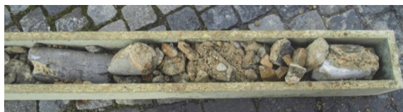
Bild 4 Bohrkiste mit »Bohrkern«
