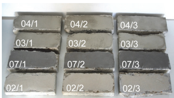
Bild 7 Probekörper aus Muschelkalk mit den Schlämm-Applikationen
