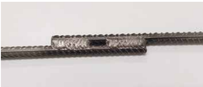
Bild 11: Beispiel für einen geschweißten Überlappstoß
