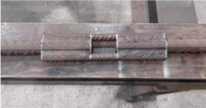
Bild 13: Beispiel für einen geschweißten Laschenstoß
