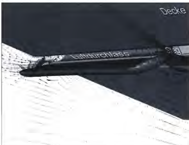
Bild 4.7. Turbulenz und Strömung unterhalb des Luftdurchlasses, einseitige Einblasung.
