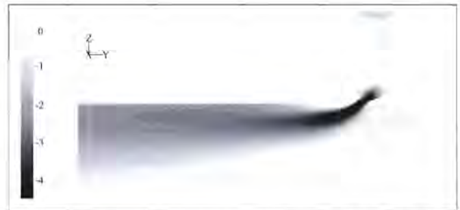
Bild 4.2. Berechnete y-Komponente der Geschwindigkeit (LDA in Bild 3.3).
