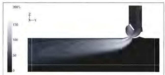
Bild 4.3. Berechneter Turbulenzgrad in der Hauptströmung (LDA in Bild 3.4).
