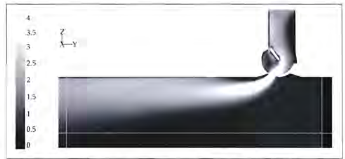
Bild 4.1. Berechneter Betrag der Geschwindigkeit in der Hauptströmung (LDA in Bild 3.2).
