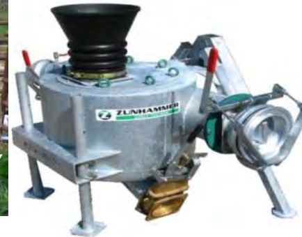
ZASTA – Andockstation und Fremdkörperabscheider
