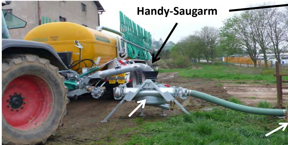
ZASTA – Andockstation und Fremdkörperabscheider
