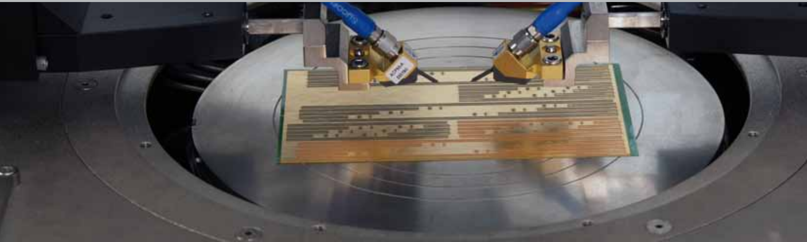
On-wafer-Messplatz mit HF-Messspitzen
