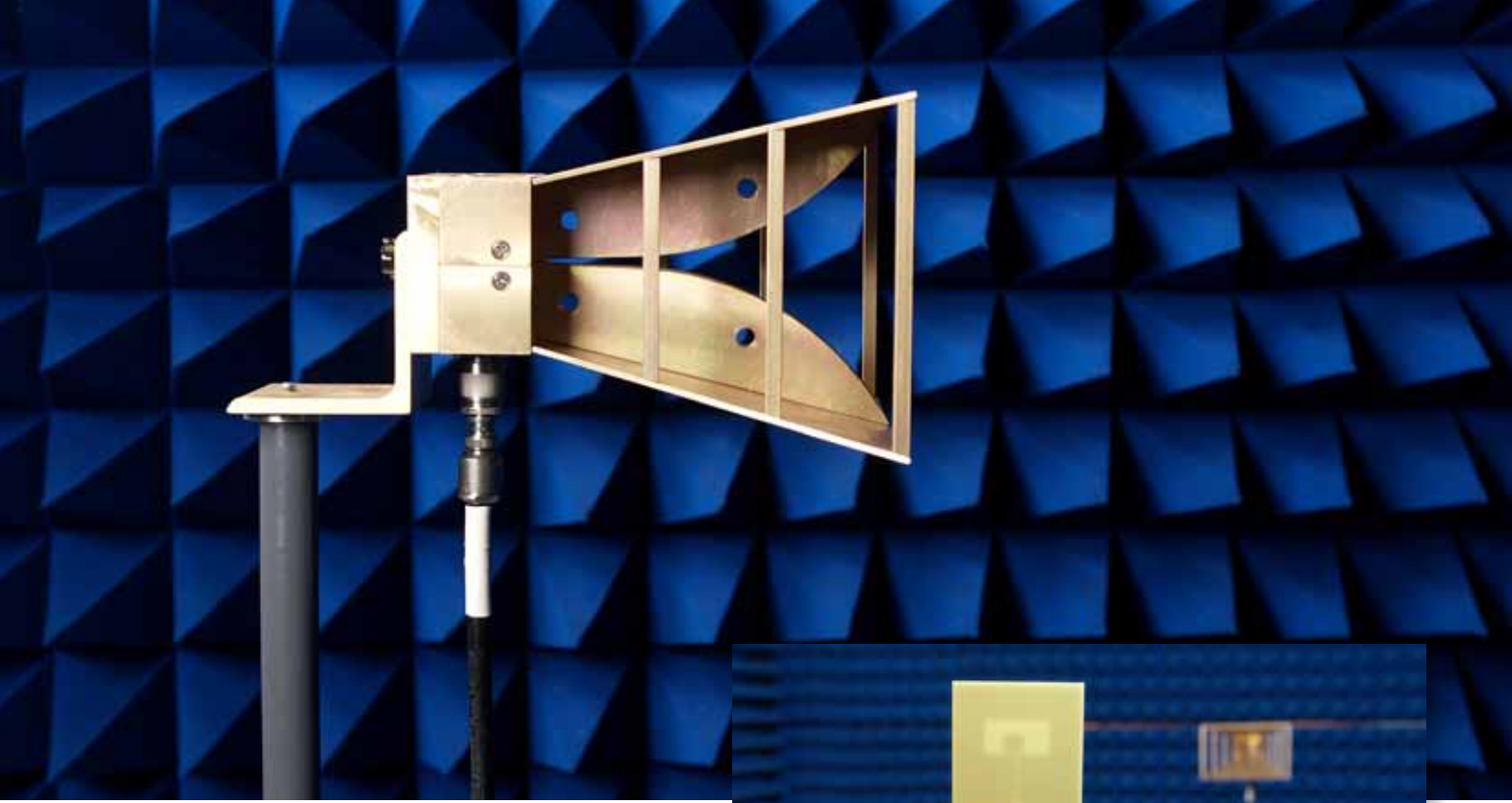
EMV-Absorberkabine zur Bestimmung der Abstrahleigenschaften integrierter Antennen
