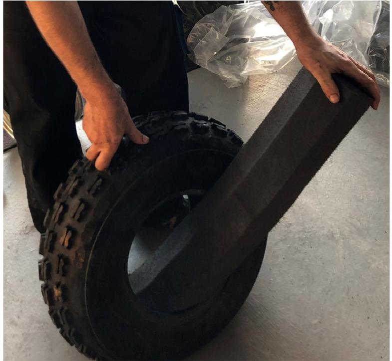
Solltest du Probleme beim Aufpumpen des Reifens haben, entferne den Ventileinsatz und schiebe den Johnny mit einem schmalen Metallstift oder einem Schraubenzieher durch den Ventilschlauch zurück – vom Ventil weg.
