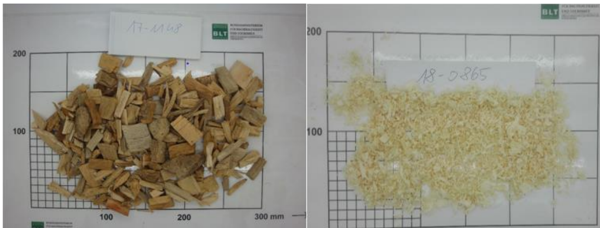
Abbildung 8: Versuchsbrennstoff 1 – Hartholz-Hackgut und Versuchsbrennstoff 2 - Hobelspäne
