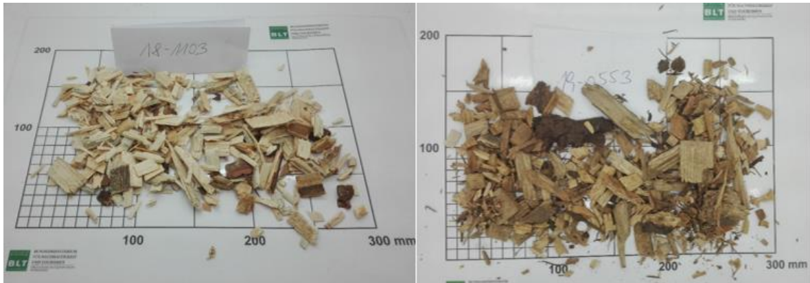
Abbildung 9: Versuchsbrennstoff 3 – Waldhackgut (hohe Qualität) und Versuchsbrennstoff 4 – Waldhackgut (Schlechte Qualität)
