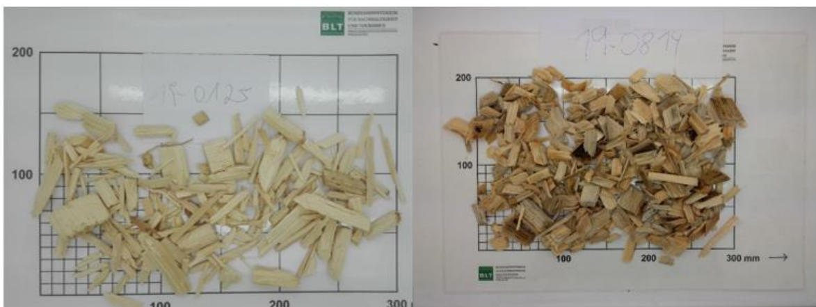
Abbildung 10: Versuchsbrennstoff 5 – Industriehackgut (ohne Rinde) und Versuchsbrennstoff 6 – Hackschnitzel frisch (hoher Wassergehalt)
