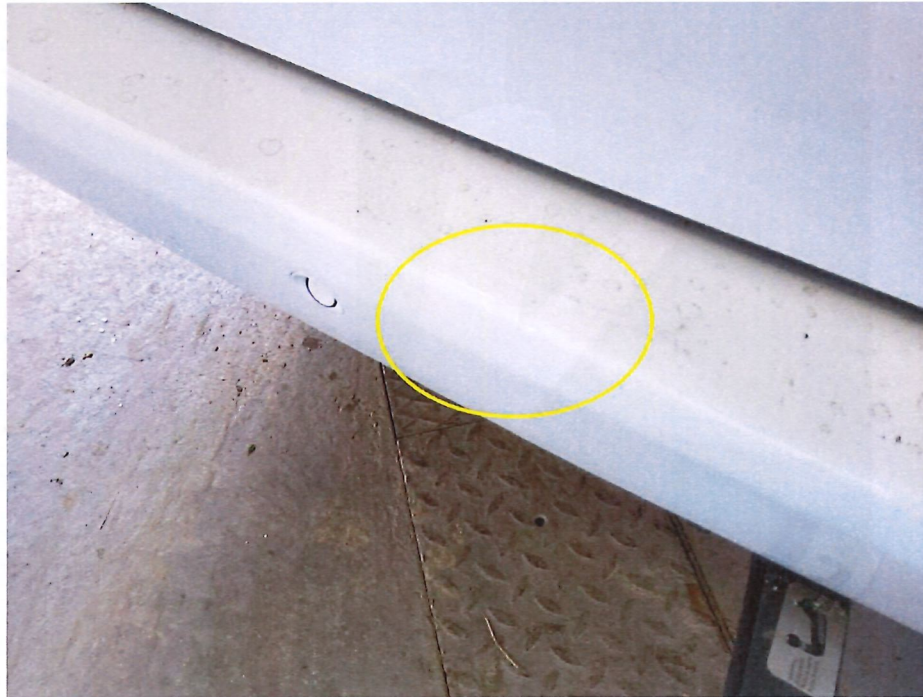
Bild 19 : Stoßfänger hinten verkratzt
