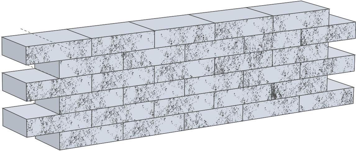
Halb- oder Passsteine können bauseits zugeschnitten werden (glatte Schnittkanten aus optischen Gründen zur Mauer hin versetzen)
