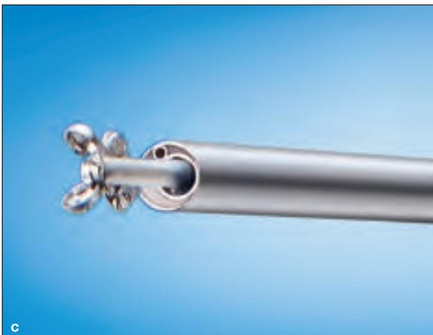
◀ Abb. 3.5a–c Endoskop für interventionelle Therapie mit einem Außendurchmesser von 1,6 mm ( a ). Die Detailansicht des distalen Endes zeigt den optischen Kanal und zwei weitere Kanäle, den kleineren Spülkanal und den größeren Instrumentierkanal ( b ), Detailansicht mit Instrument im Arbeitskanal ( c ).
