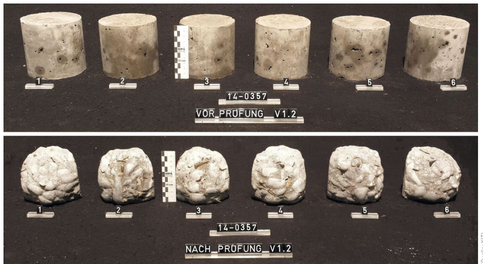
Bild 11 Betonabtrag nach 22-stündiger Versuchsdauer an zylinderförmigen Prüfkörpern Concrete wear of cylindrical samples after 22 h of exposure
