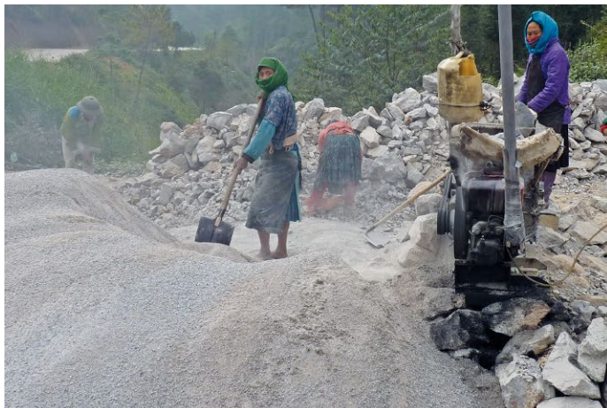
Bild 9 Brechen von Kalkstein (links) und Siebung von Sand (rechts) Crushing of limestone (left) and sand sieving (right)
