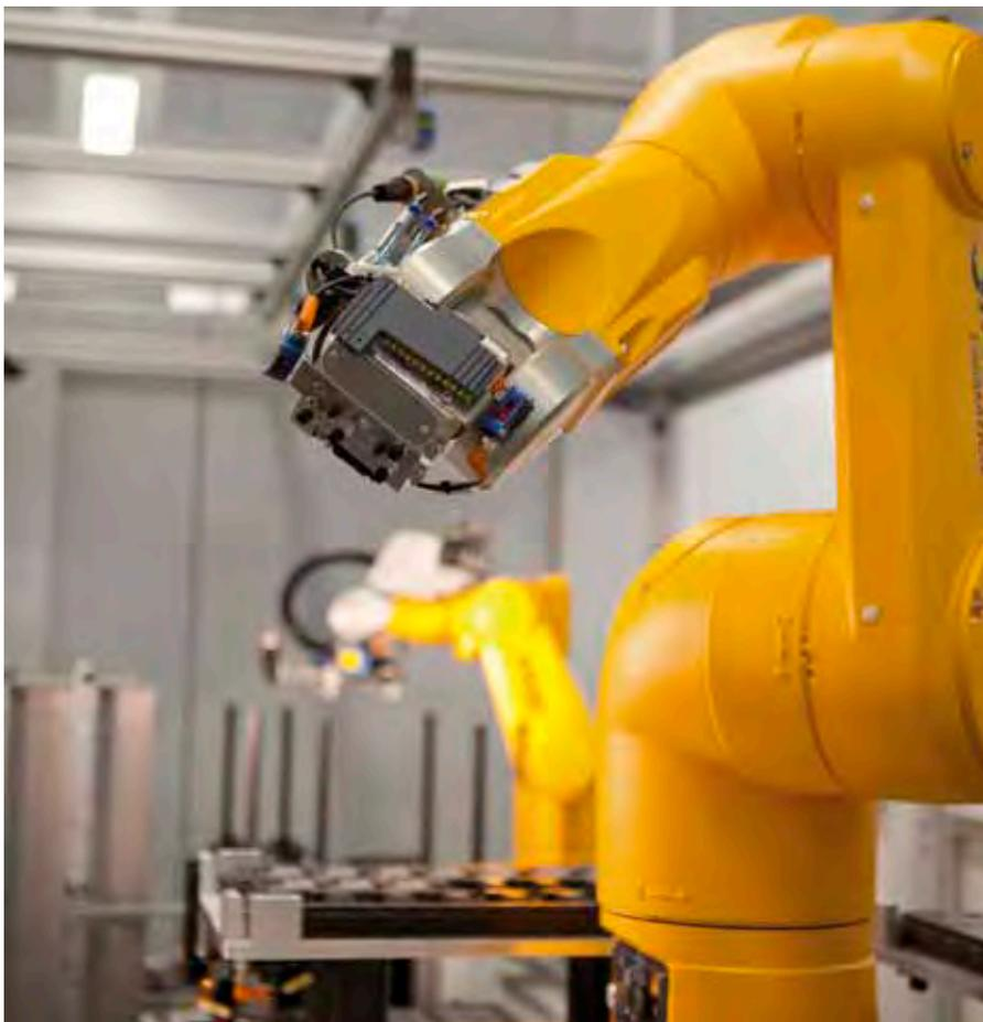
Das Umladen in spezielle Teileträger für die Prüfung erledigt ein Knickarmroboter, der sich auf einer Linearachse bewegt und dessen Bewegungen ebenfalls ein B&R System steuert.
