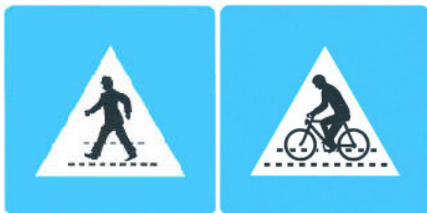
Abbildung 9: Hinweiszeichen „Kennzeichnung eines Schutzweges“ (li), Kennzeichnung einer Radfahrerüberfahrt (re)
