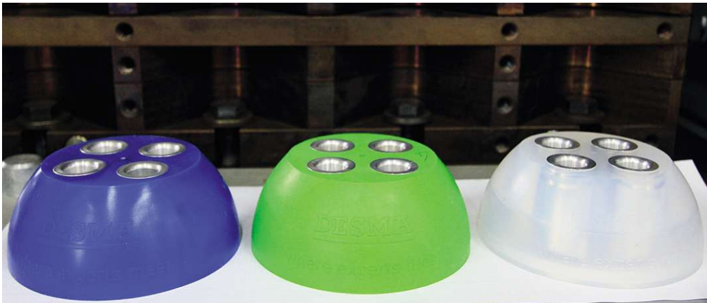
Ein Demoartikel mit vier Ein- teilen wurde aus HTV (blau), EPDM-Gummi (grün) und LSR (transparent) jeweils unter Nutzung der Forminnendruckmessung her- gestellt. Die entsprechenden Druckkurven während des Zyklus sind ebenfalls gezeigt wobei die Heizzeiten je nach Material angepasst wurden.
