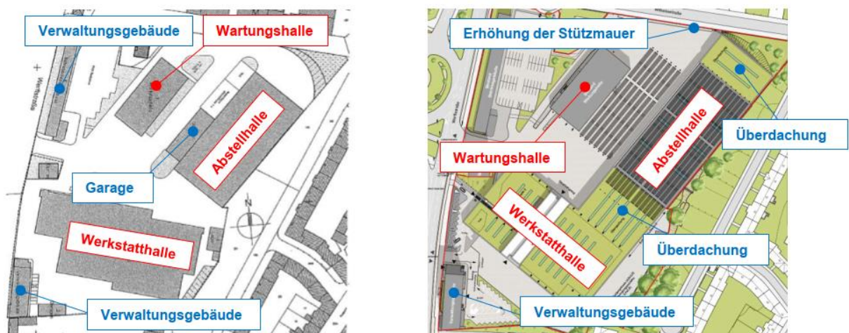
Abbildung 5: Busbetriebsbahnhof, Bestand (links) und Modernisierung (rechts)
