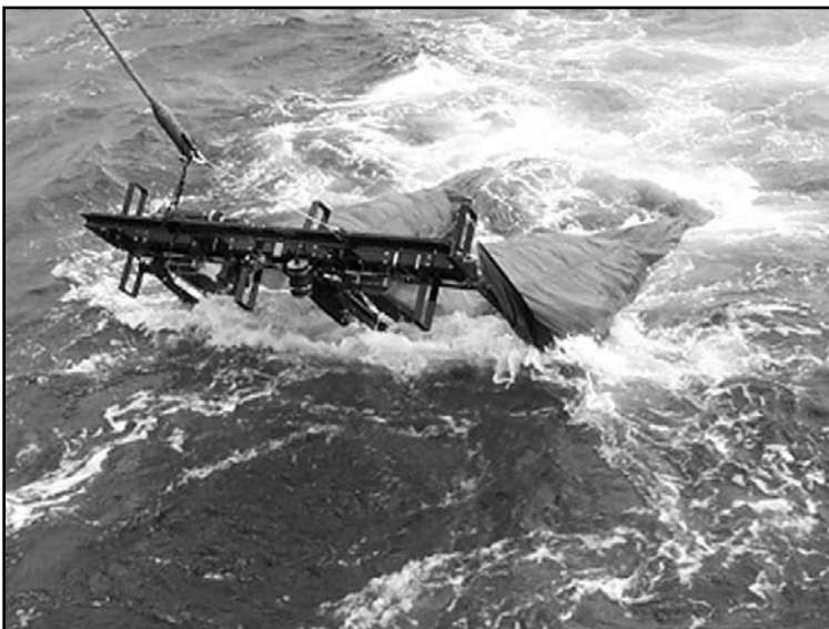
Abb. 3.22-4: Das 1 m 2 MOCNESS (Multiple Opening and Closing Net and Environmental Sensing Unit) kommt zurück an Deck.
