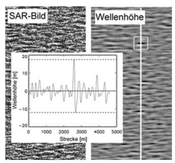
Abb. 2.4-12: Synthetic Aperature Radar (SAR) — Bild und zugehörige Wellenhöhe. Mit eingefügt ist das Diagramm mit einer sehr hohen Wellenhöhe von 29,8 m (entlang der weißen Linie). Quelle: S. Lehner, DLR, aus Bruns (2006).
