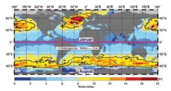
Abb. 2.4-9: Globale Verteilung der Maxima der signifikanter Wellenhöhen (Eigene Darstellung - Datenquelle: ERA-Interim 1989-2012).
