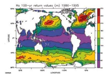
Abb. 2.4-13: Maxima der signifikanten Wellenhöhe für ein Wiederholungsintervall von 100 Jahren, berechnet aus Seegangsvorhersagen für den Zeitraum 1986-1995 1995 (Quelle: http://www.knmi.nl/waveatlas/license.cgi - Stand 16.09.2013).
