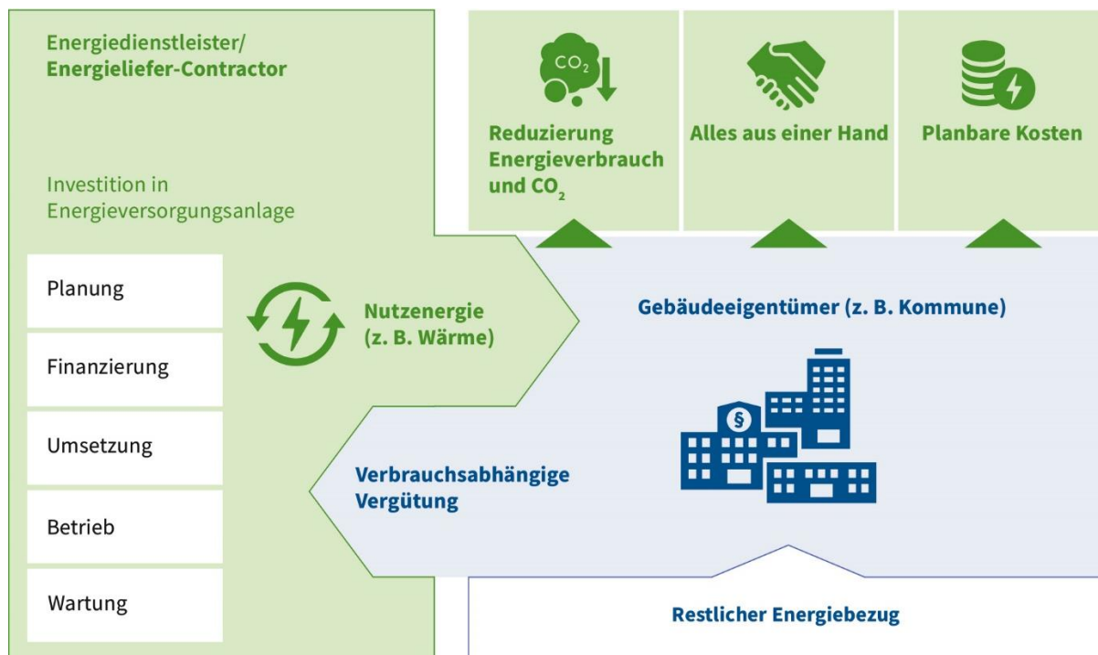
Abbildung 9 So funktioniert ELC: Der Energiedienstleister kümmert sich um die Energieversorgung und erhält dafür einen investitionsabhängigen Grund- und einen verbrauchsabhängigen Arbeitspreis.
