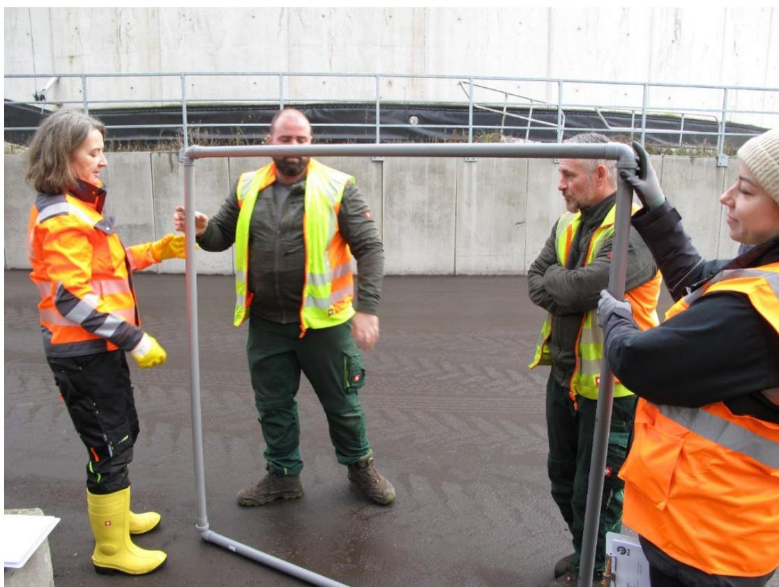
Abbildung 3: Aus Abwasserrohren zusammengesteckter Boniturrahmen. 4 Rohre à 1,5 m ergeben zusammen mit den Eckwinkeln eine Fläche von 2,5 m<sup>2</sup>. 2 Boniturrahmen à 2,5 m<sup>2</sup> bilden ein 5 m<sup>2</sup>-Boniturfenster.
