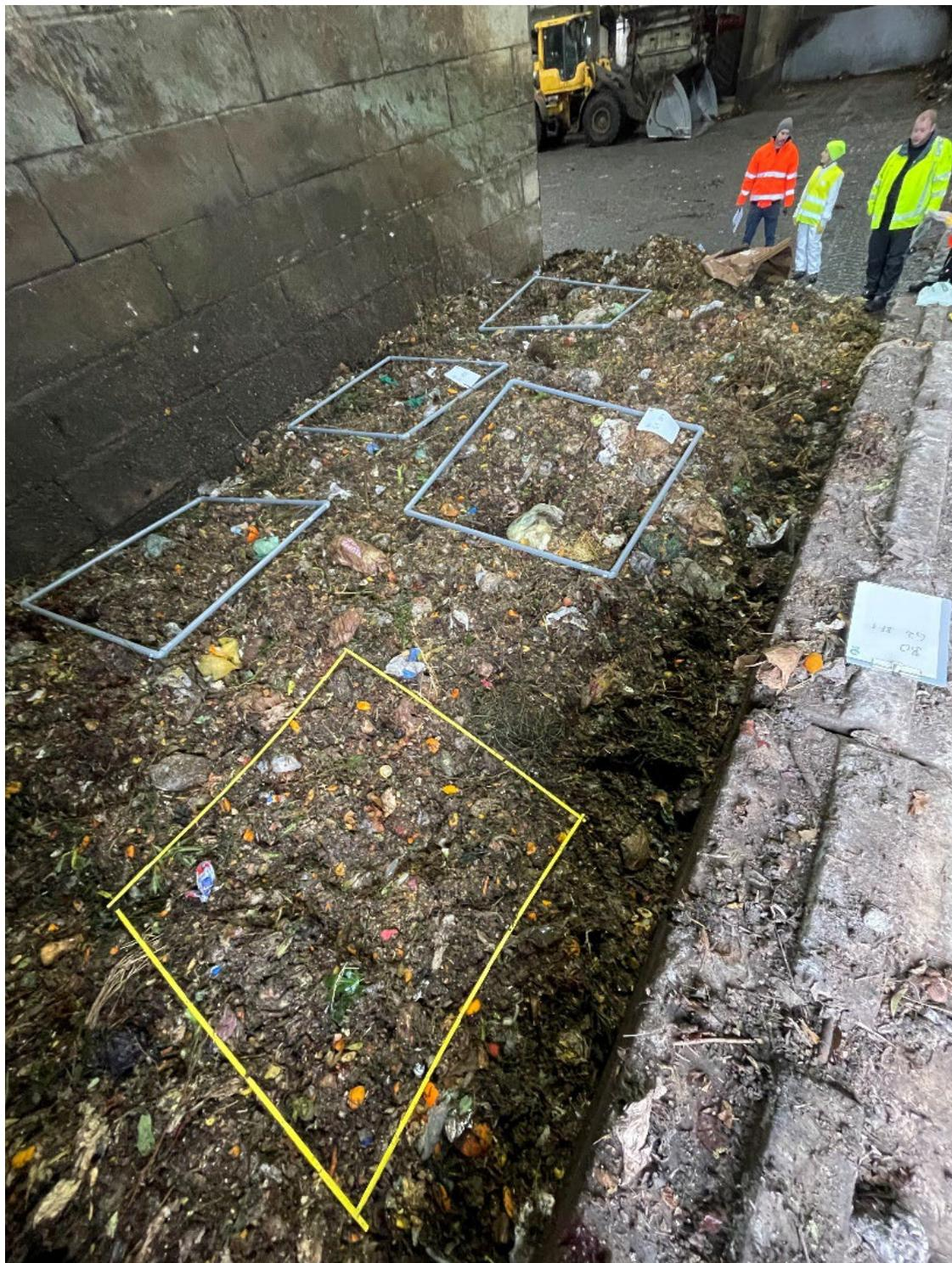
Abbildung 4: Auf der flächig verteilten Charge aufgelegte Boniturrahmen von je 2,5 m<sup>2</sup> aus zusammengesteckten grauen Abwasserrohren. 2 Boniturrahmen ergeben zusammen ein 5 m<sup>2</sup>-Boniturfenster.
