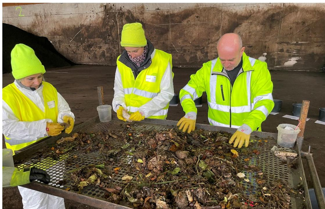
Abbildung 14: Das zu sortierende Material wird portionsweise auf den Sortiertisch aufgegeben und sortiert.
