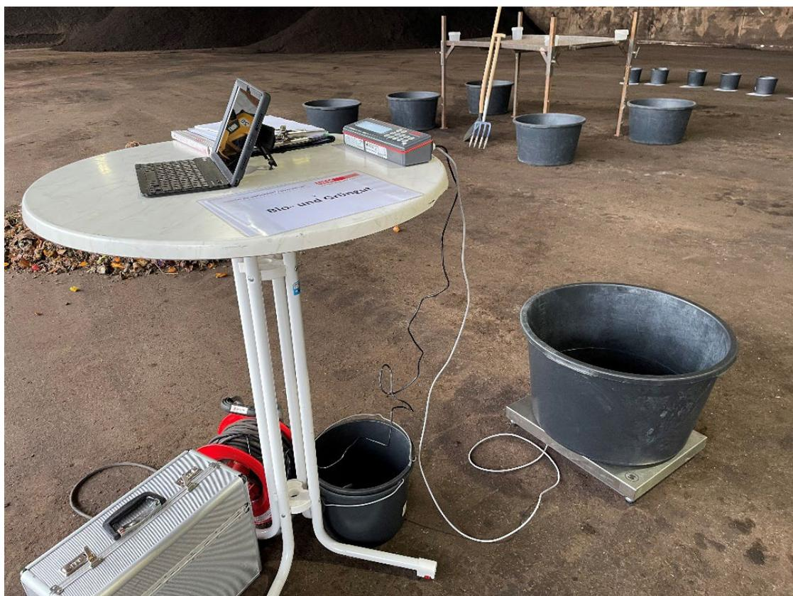
Abbildung 18: Station zur Datenerfassung mit Waage
