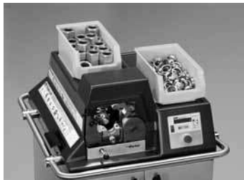
Behälter können auf den Plattformen gelagert werden
