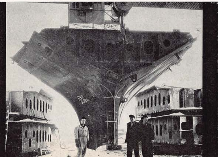
Ein Hinterstevenskollis wird von Meister Laudam, Vorarbeiter Mafner und Anschläger Ferber abgeliefert. Den Kran fährt Kranführer Griepentrog.
