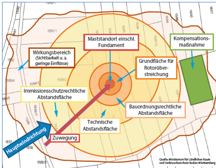
Abb. 1: Schematische Darstellung einer WEA (Quelle: MLR Baden-Württemberg)
