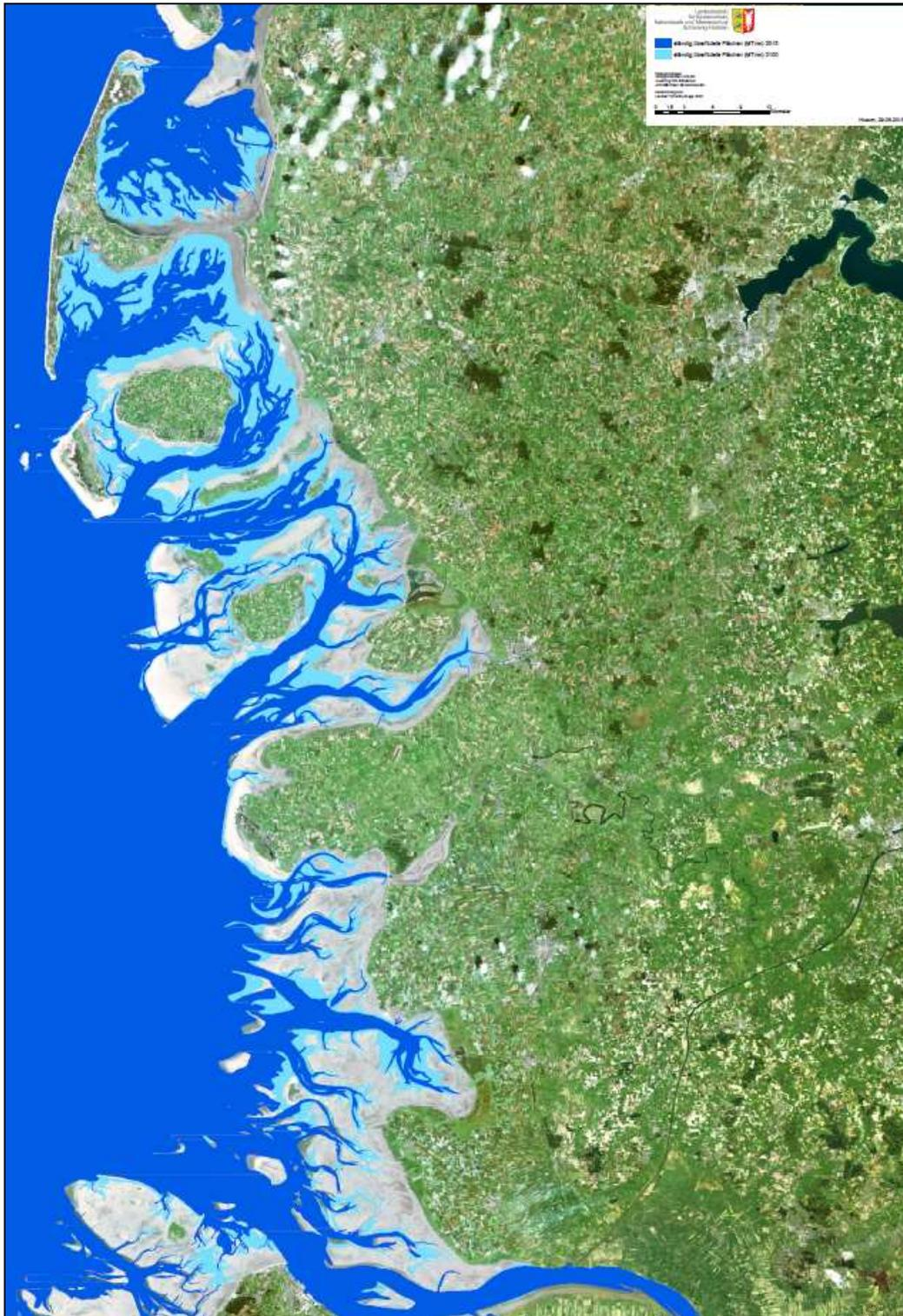
Schematische Darstellung zur Visualisierung der Folgen eines Meeresspiegelanstieges, wenn kein oder nicht genug Sediment importiert wird (Zunahme der permanent mit Wasser bedeckten Flächen) .
