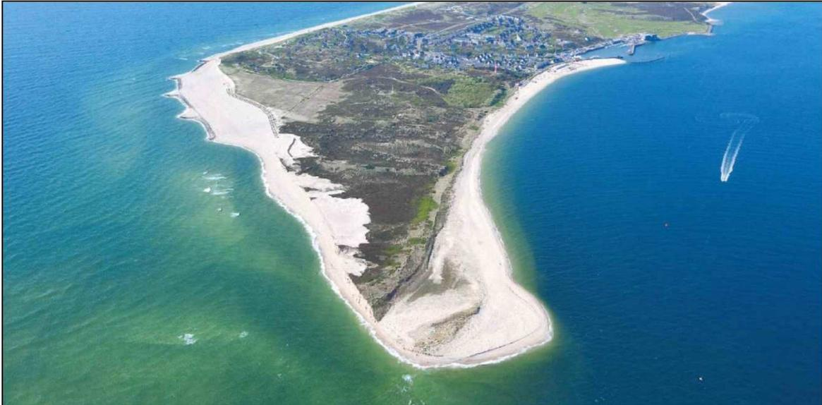
An der Westküste von Sylt aufgespültes Sediment wird durch den Küstenlängstransport in Richtung der Tiderinnen transportiert und dürfte von dort flächig ins Wattenmeer verteilt werden. Die Transportbänder sind als grünliche Sandriffe im Wasser erkennbar.
