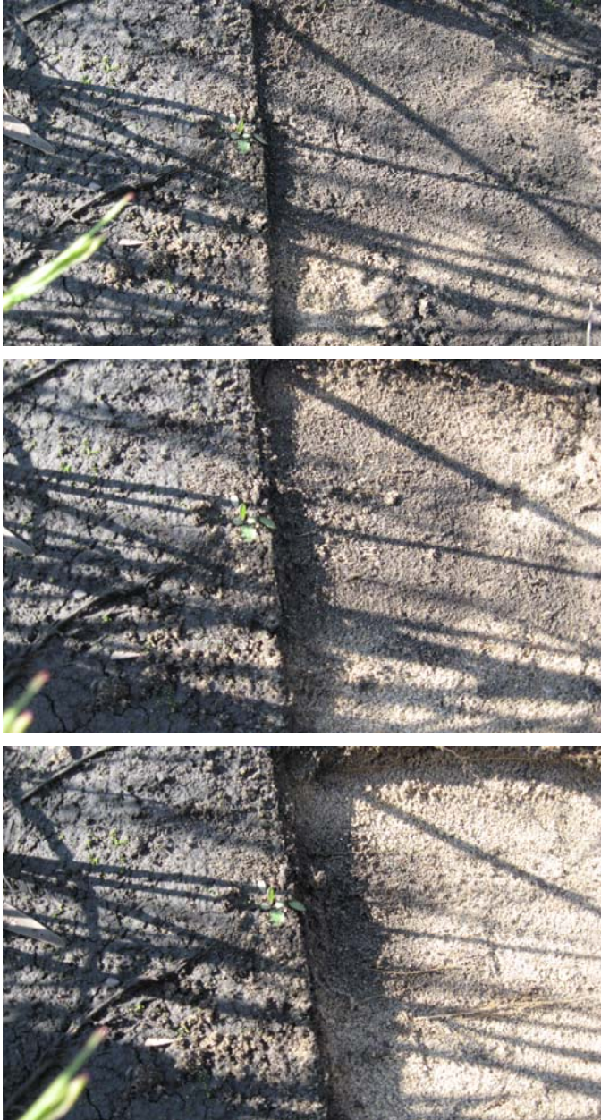
Bild 3-8: Schurf an der Filteroberkante Bereich Zulauf, linke Seite ohne Schurf; rechte Seite mit Schurf 1 mm (Bild oben), Schurf 5 mm (Bild Mitte) und Schurf 10 mm (Bild unten) jeweils unter Filteroberkante, 19.04.2011
