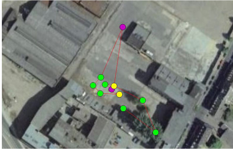
Abbildung 8: Bohrpunkte mit Farbklassen für Schadstoffgehalte (Mittelwerte für Tiefenintervall)
