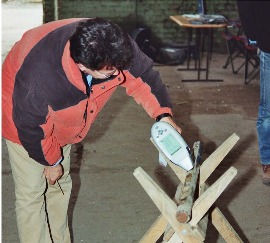
Abbildung 3: Schwermetallmessung mittels mobiler RFA ohne Probenvorbereitung direkt in der Sonde
