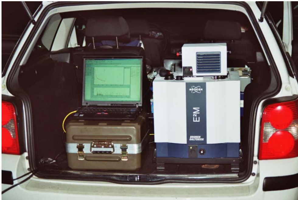
Abbildung 4: Mobiles GC-MS-System zur Messung organischer Verbindungen
