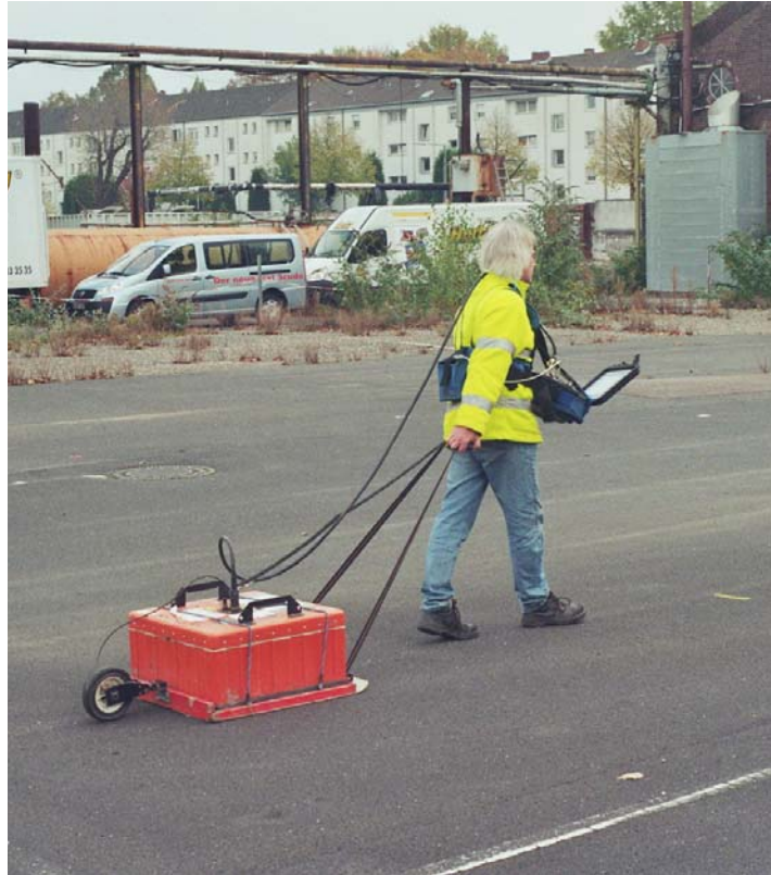
Abbildung 2: Georadaruntersuchung; Aufzeichnung von Profilen im 1m-Abstand
