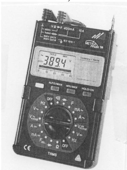
Abb. 6.15: Digitales Vielfachmessgerät
