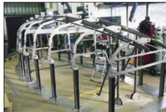
Die Gurten werden auf die Auflagenpfosten geschraubt und mit den Spanten gesteckt
