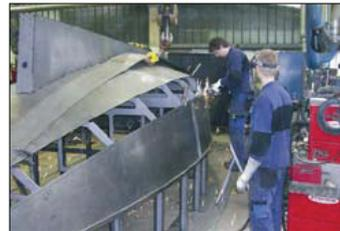
Das Gerippe wird mit Stahlblech 3 und 4 mm einfasst
