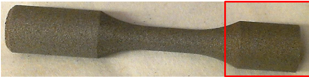
Abbildung 47: Probe C_00 mit einer einseitig um 7,78 mm verkürzter Einspannlänge
