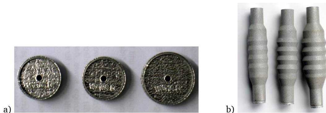
Abbildung 46: a) Hergestellte Käppchen für die Gehäuse V02T05, V02T08 und V02T18 b) Hergestellte Aktormodulgehäuse V02T05, V02T08 und V02T18 (von links nach rechts)
