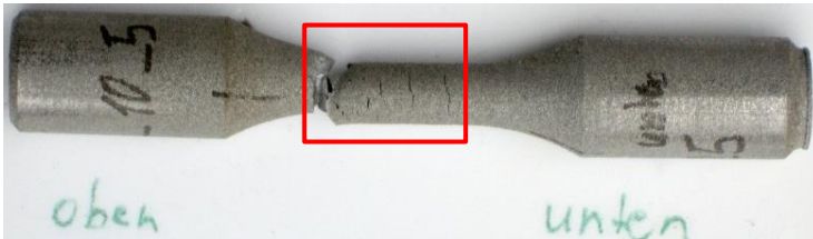
Abbildung 67: Probe C_10_5 gebrochen mit Oberflächenrissen ( N=173.644 , \sigma_0 = 400 \text{ N/mm}^2 )
