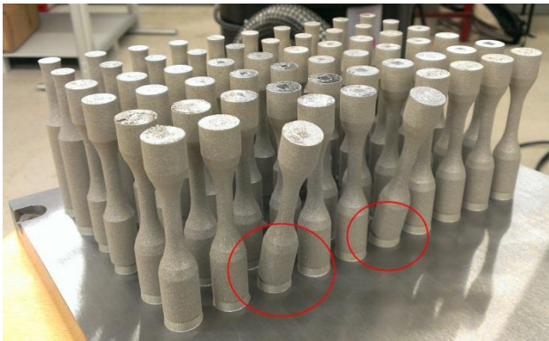
Abbildung 41: SLM-Bauplattform mit Baujob A_00_1
