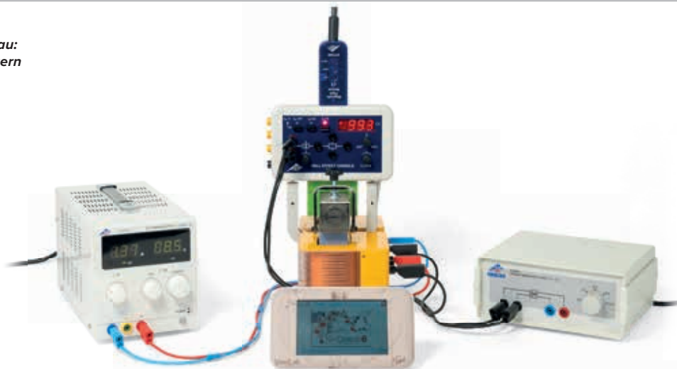
Hall-Spannung in p- und n-dotiertem Germanium als Funktion der Temperatur T.
