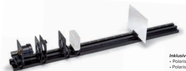
Sichtbarkeit von polarisiertem Licht in getrübbtem Wasser
