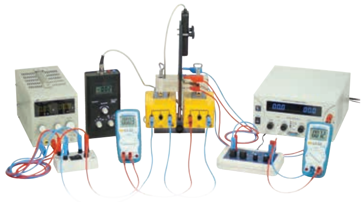
Experimenteller Aufbau: Hall-Effekt an Metallen
