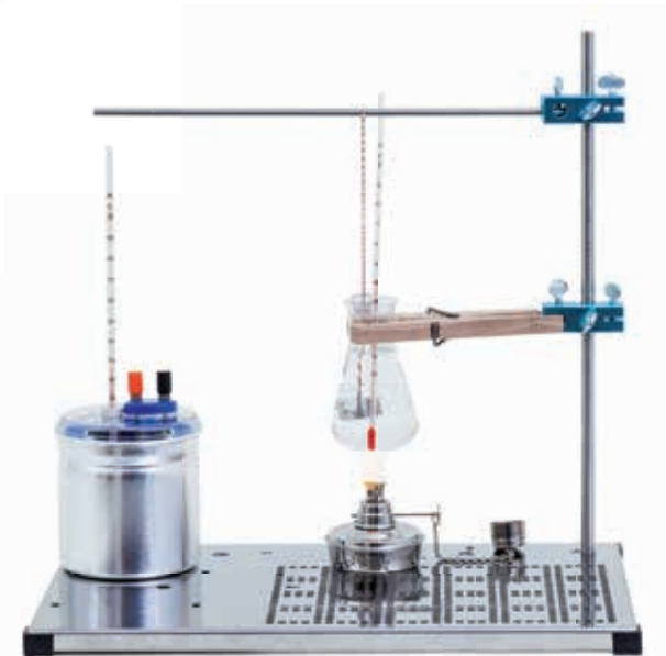
Spezifische Wärmekapazität von Metallen
