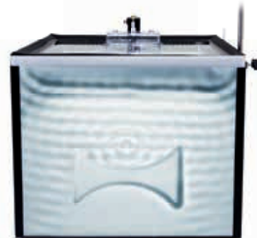
Reflexion von Wasserwellen an einem „Hohlspiegel“
