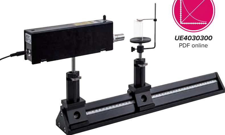
Erzeugung von Zweistrahlinterferenz mit einem Fresnel'schen Biprisma
