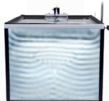
Brechung von Wasserwellen an einer Sammellinse
