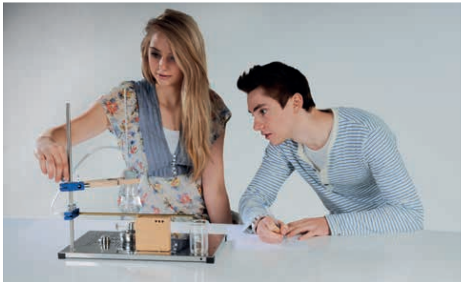
Längenänderung fester Körper bei Erwärmung
