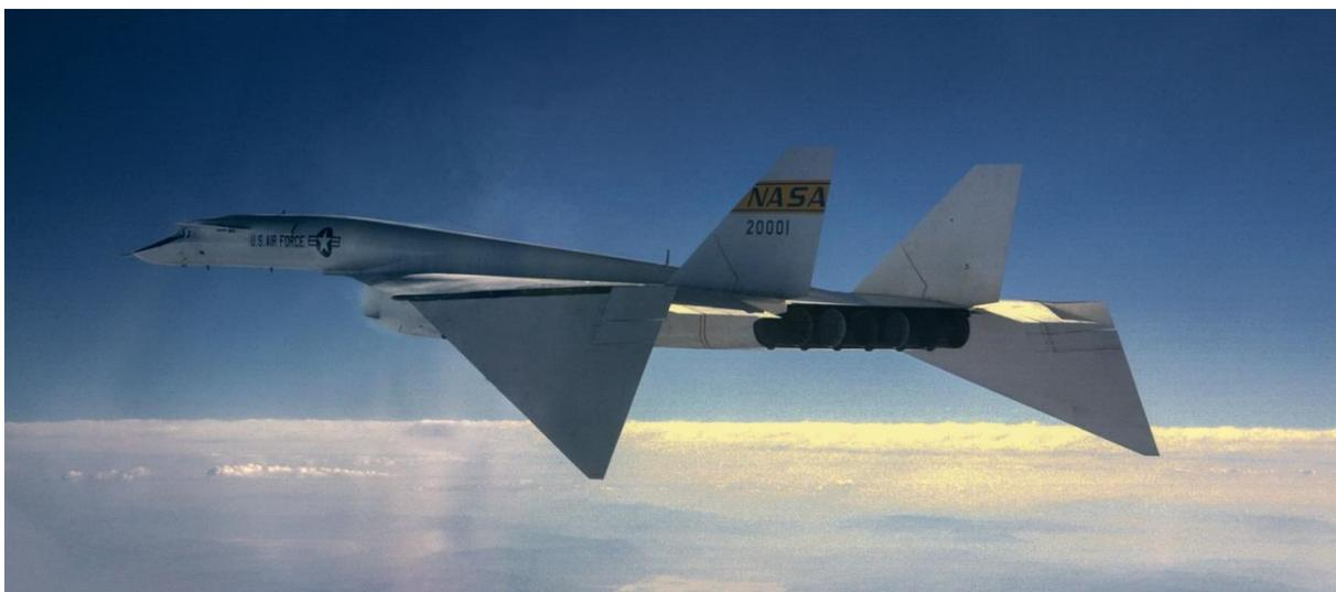
Abbildung 16: XB-70 Valkyrie mit herunter geklappten Flügeln / Quelle: Google
