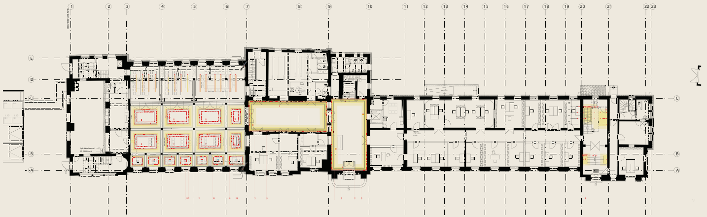
Abb. 64 Aufwändige Lichtkonzeption für Aufenthaltsraum (Deckensegel), Foyer und Flur des Erdgeschosses
