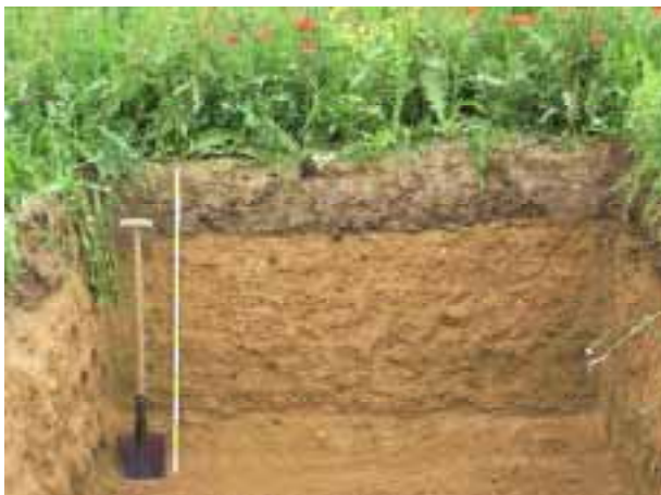
Ober- und Unterboden einer locker eingebauten Rekultivierungsschicht.
