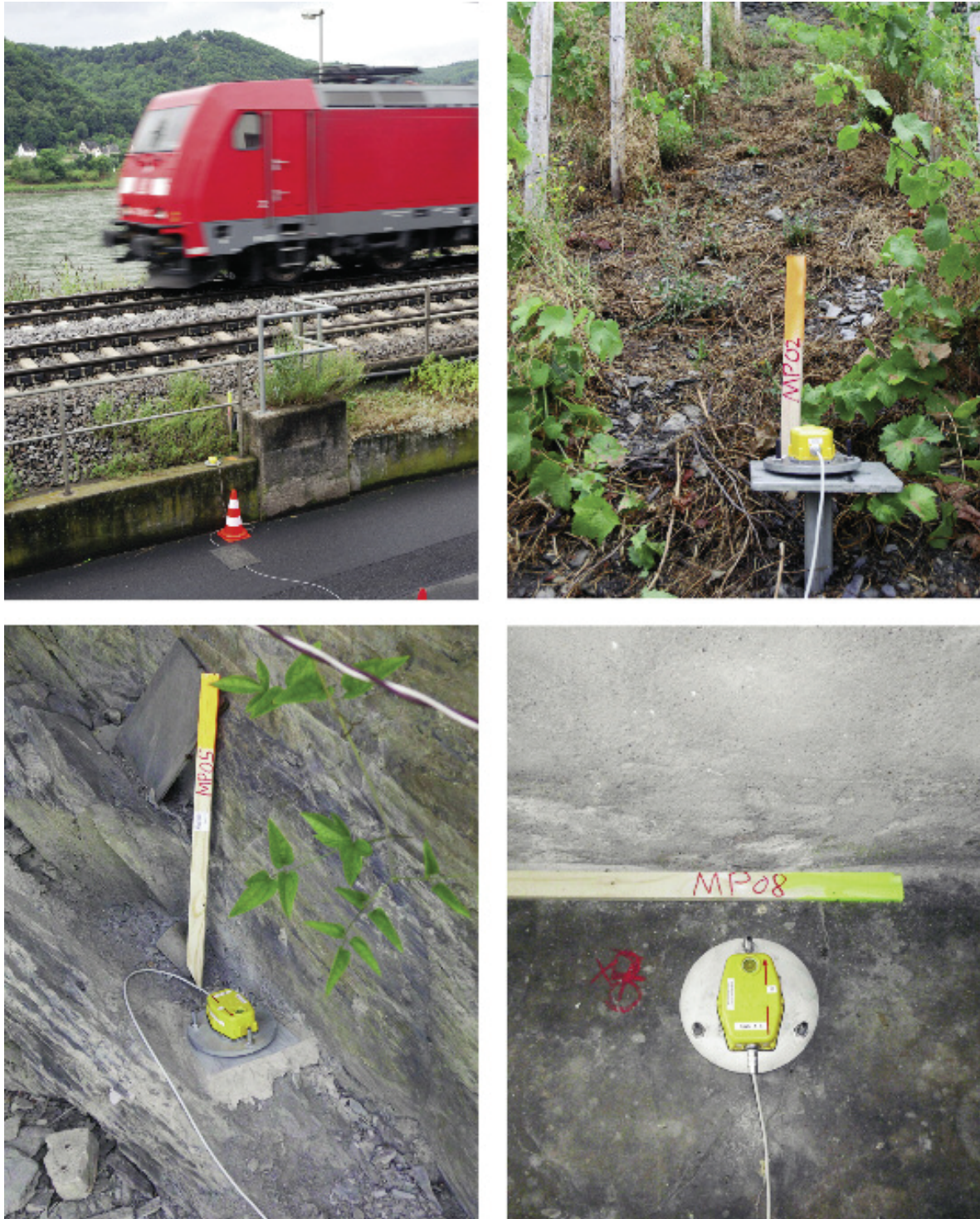
Abb. 10: Fotodokumentation verschiedener Messpunkte für die Erschütterungsmessungen: Bild oben links: Profil 2 – MP 1: Messpunkt auf der Mauer neben dem Gleis (Bauteil); Bild oben rechts: Profil 2 – MP 2: Messpunkt im Weinberg (Erdspieß im Lockergestein); Bild unten links: Profil 2 – MP 5: Messpunkt auf einen präparierten Felssims (Festgestein) oberhalb des Weinbergs; Bild unten rechts: Profil 1 – MP 8: Messpunkt auf dem Fundament (Keller; Bauteil) (Fotos: LUWG vom 06.08. und 07.08.2013).
