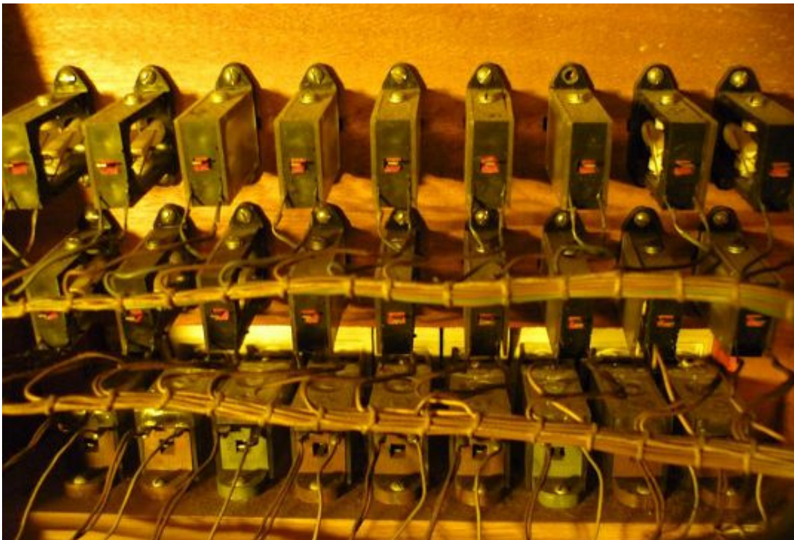
...und so sehen die Registerschalter von der Rückseite aus. Die Leitungen führen...
