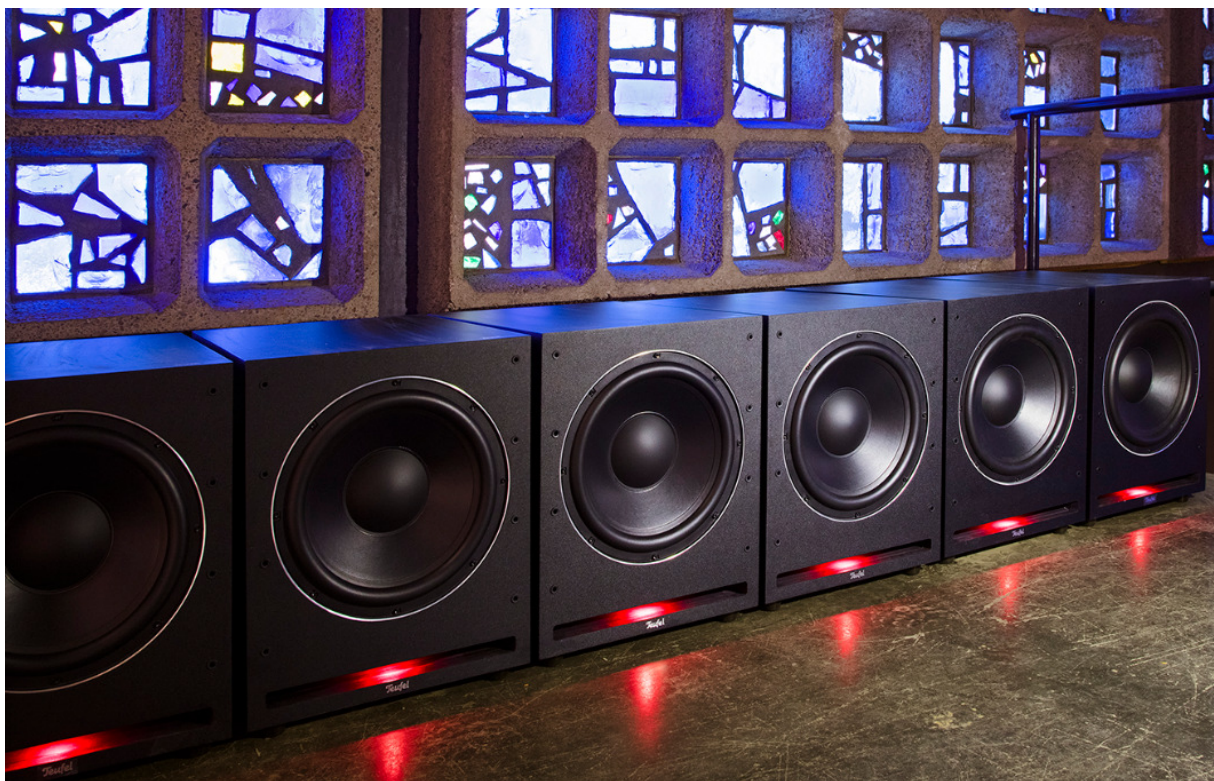
Subwoofer auf der Empore hinter der Orgel mit Tieftonwiedergabe herab bis 16Hz
