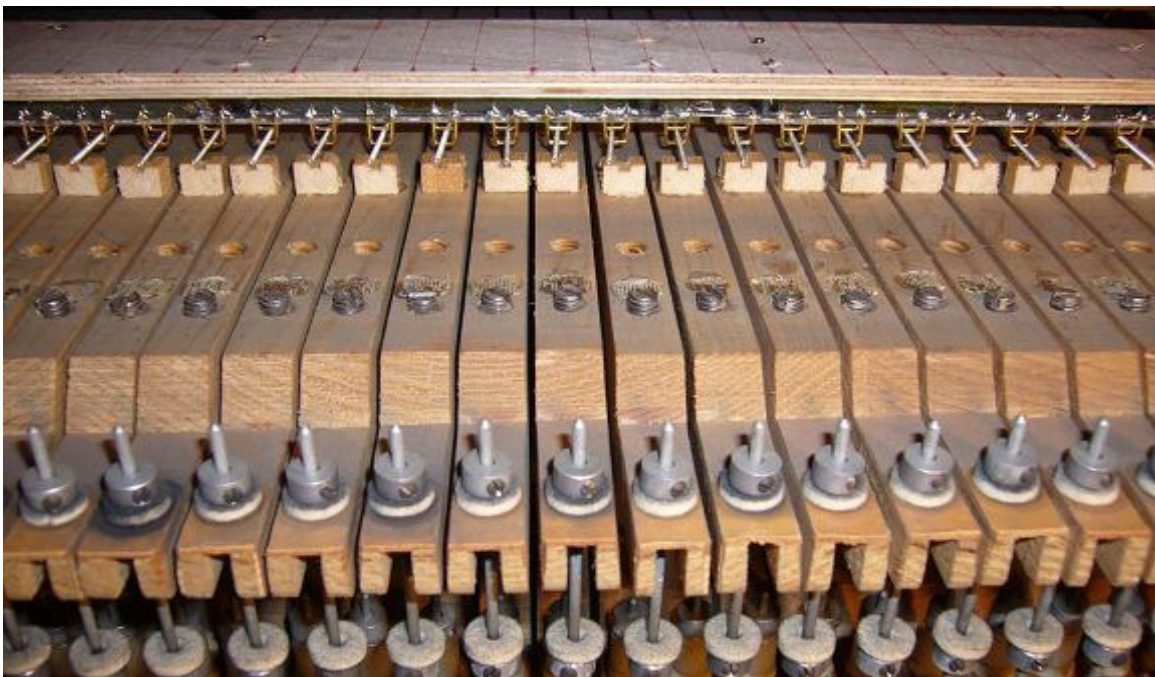
Im Spieltisch: Das anschlagsdynamische Midi Interface auf dem Schwellwerkmanual
