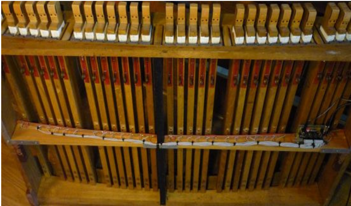
Das mit Hallsensoren auf der Unterseite midifizierte 30 Tasten Pedal
