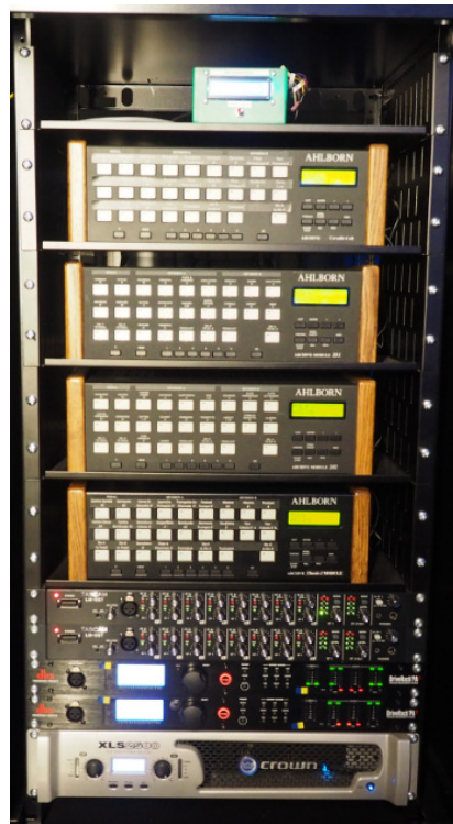
Rack hinter der Orgel mit Ahlborn Midi-Soundmodulen, Mischpulten, digitalen Frequenzweichen und Verstärker
