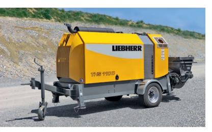
Die Pumpeinheit ist auf einem besonders robusten Stahlrahmen montiert. Das stabile Blechgehäuse sorgt für Wetterschutz und Schallreduzierung. Im Ansaugbereich schützt ein großes Stahlgitter das Kühlsystem und garantiert Reserven bei der Kühlleistung. Alle Komponenten sind kompakt integriert und durch ein modernes Design verkleidet.
