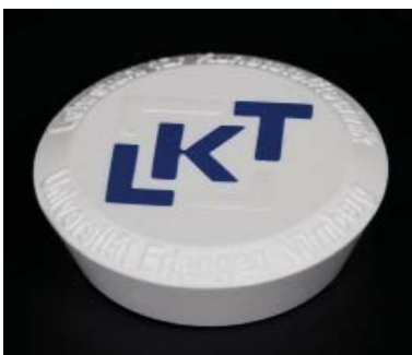
Herstellung im Einlegeverfahren auf einer 1K-Spritzgießmaschine
