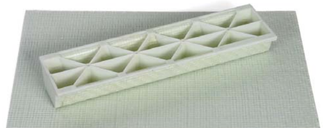
Erlanger Träger, optimiert für Kunststoff/ FVK-Hybridstrukturen
